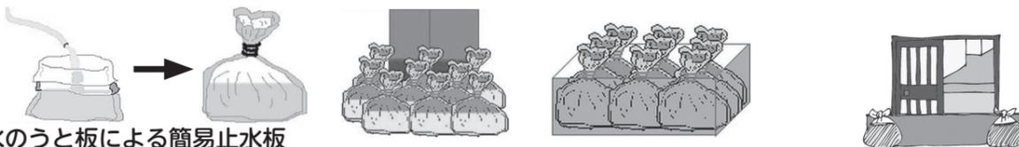
◎水のうと板による簡易止水板
