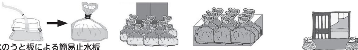
◎水のうと板による簡易止水板
