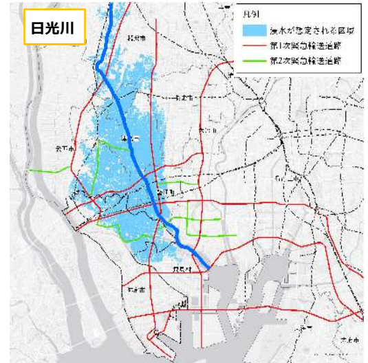
日光川からの浸水想定（広域）
