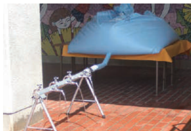
▲応急給水支援設備
